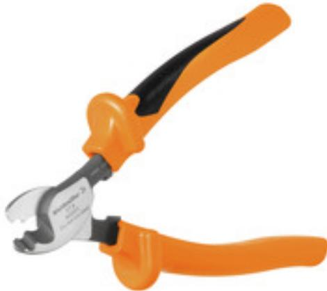
Herramientas para cortar cables de hasta 8 mm, 12 mm, 14 mm y 22 mm de diámetro exterior. La geometría especial de la cuchilla permite un corte sin estrangulamiento de conductores de cobre y aluminio, con esfuerzo físico mínimo. Las herramientas para cortar incluyen además aislamiento de protección sometido a pruebas VDE y GS de hasta 1000 V de conformidad con la normativa EN/IEC 60900.
